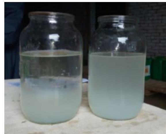
Спрей-Ейд – совмещение препаратов, стабилизация pH Слева – без Спрей-Ейд (осадок), справа (Спрей-Ейд – растворение)
